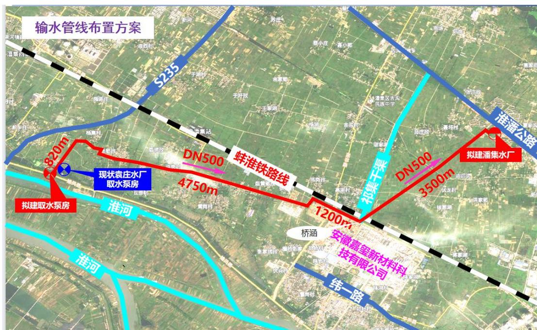
配水线路：潘集水厂供水范围主要为承建袁庄水厂供水范围以及中部未通水区域管网覆盖，新建输配水干管总长 49.6km 管网主要沿淮潘公路敷设，西接至庙后村，北至泥河镇，东至平圩镇。支管、接户管仍沿用已建管网。
